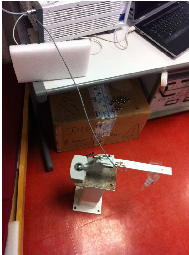
Figure 3.1-3 : Précautions prises en vue d'éviter la transmission de vibrations parasites
