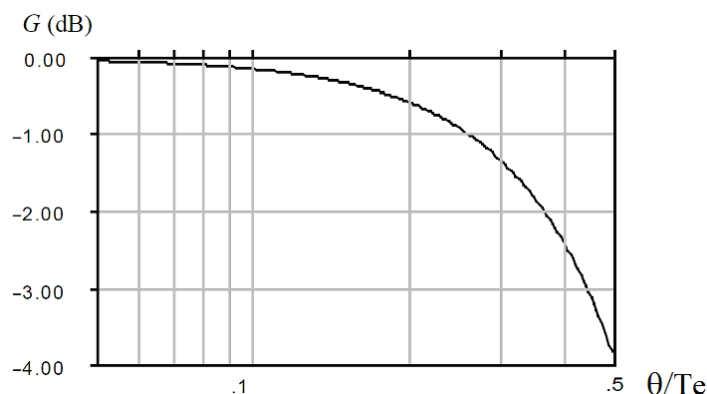
Figure 6.3-4 : Atténuation du spectre du signal à f = B en fonction du temps de blocage
