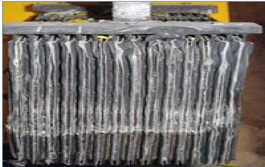
Figure 3.2: L'effet de sulfatation sur les électrodes
