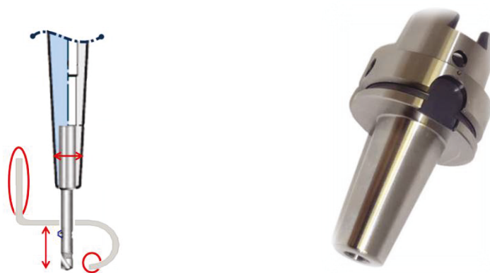
Figure 22 – Zones critiques d'encombrement procédé perçage-ébavurage
