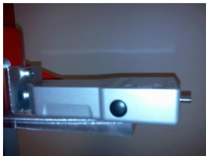
Figure 33 – Fixation dynamomètre sur équerre
