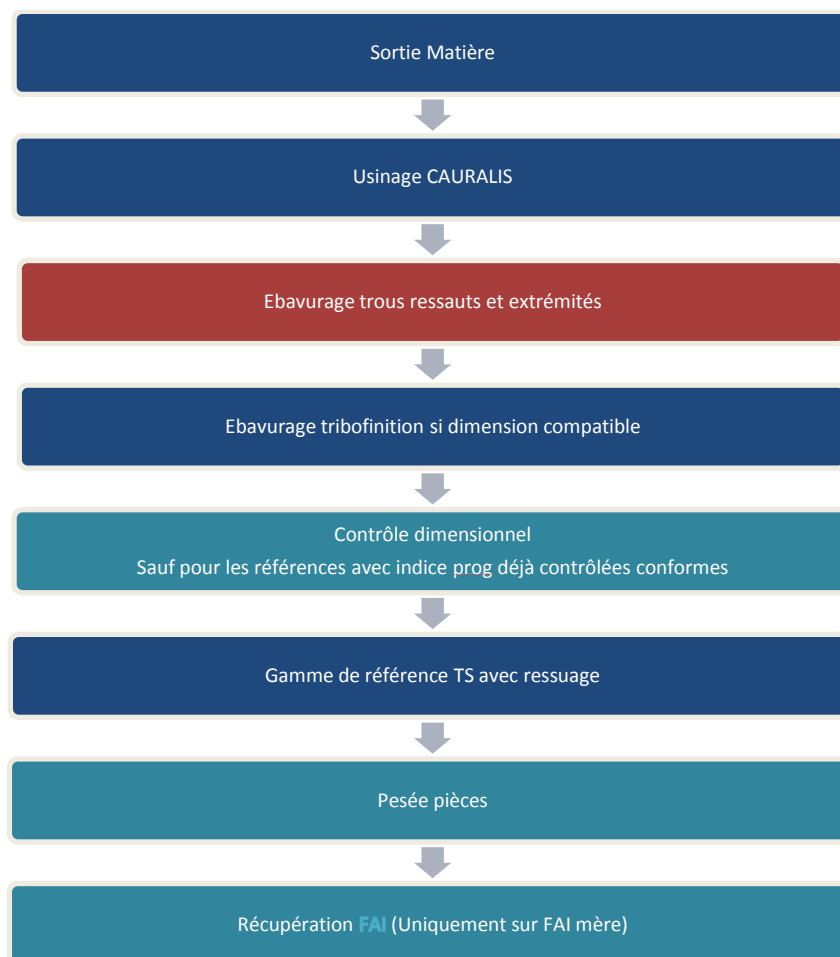
Figure 9 – Exemple de gamme pour pièce CAURALIS
