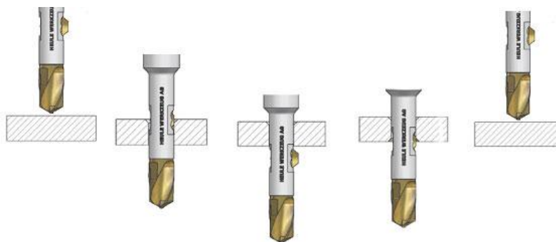
Figure 21 – Séquences de travail de l’outil VEX-S [Heule]
