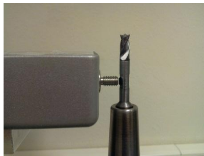
Figure 35 – placement du dynamomètre par rapport au couteau
