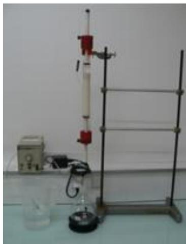
**Figure 7.** Système de colonne basse pression sur résine Amberlite™ XAD16N
