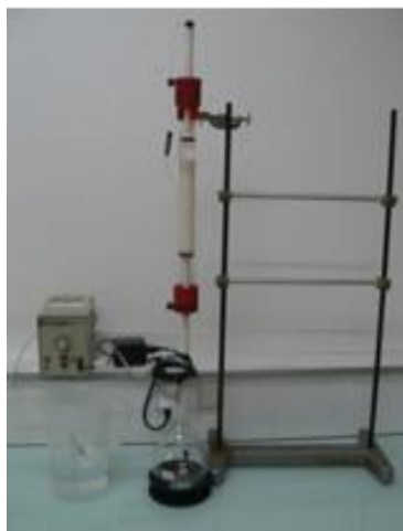
Figure 7. Système de colonne basse pression sur résine Amberlite™ XAD16N
