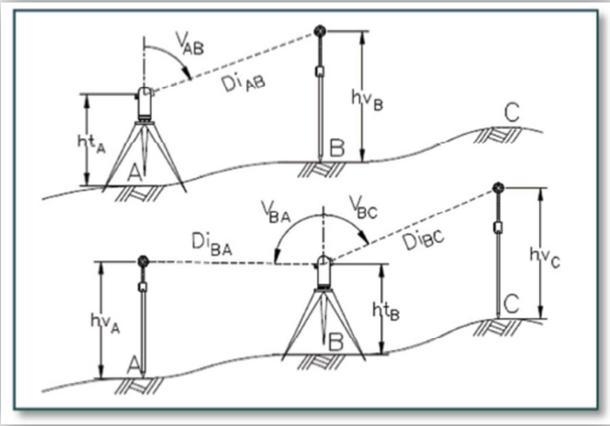
Figure 39 : Schéma explicatif de la méthode des visées réciproques
