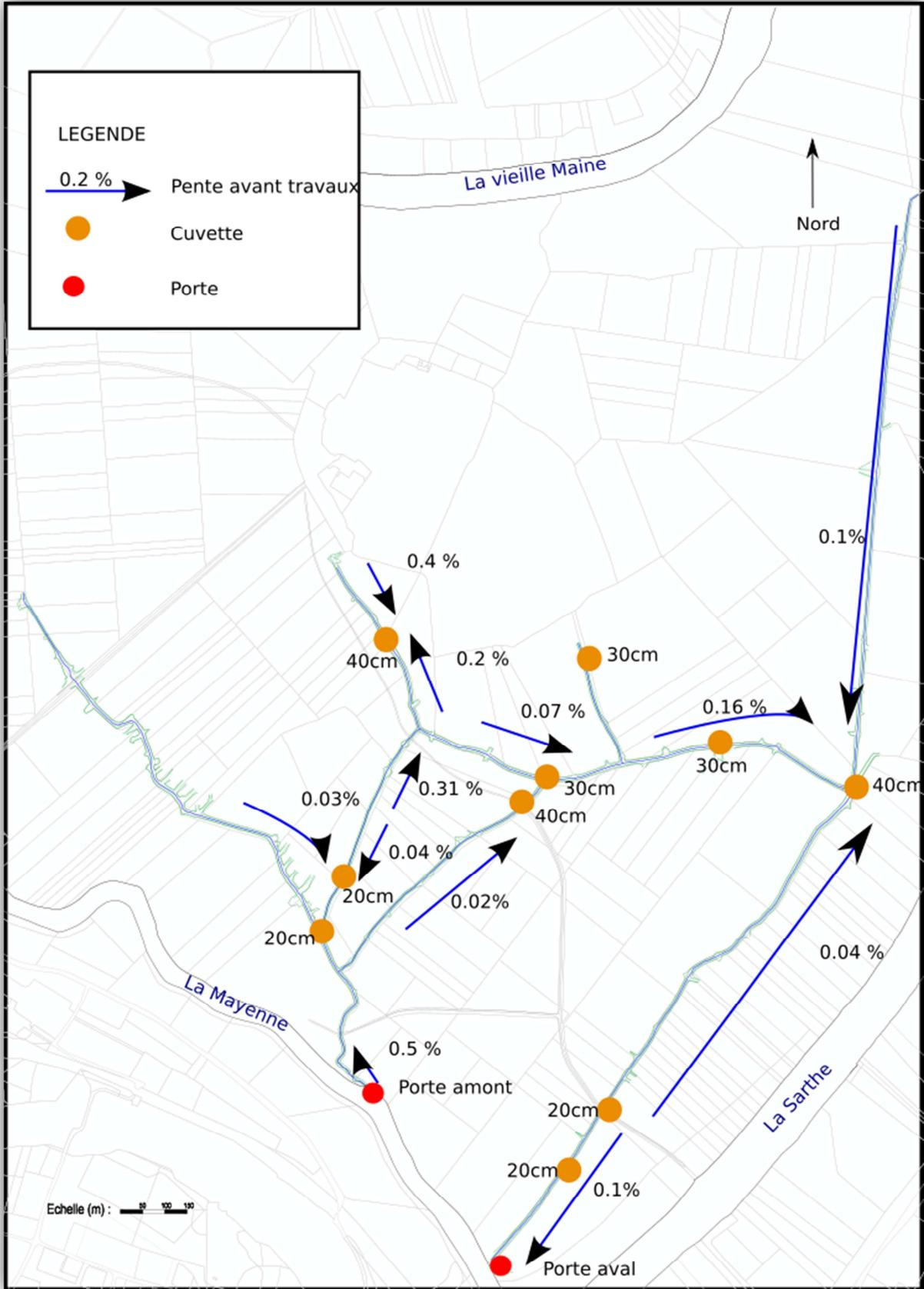
Figure 41 : schématisation des pentes actuelles et des cuvettes présentes sur les canaux
