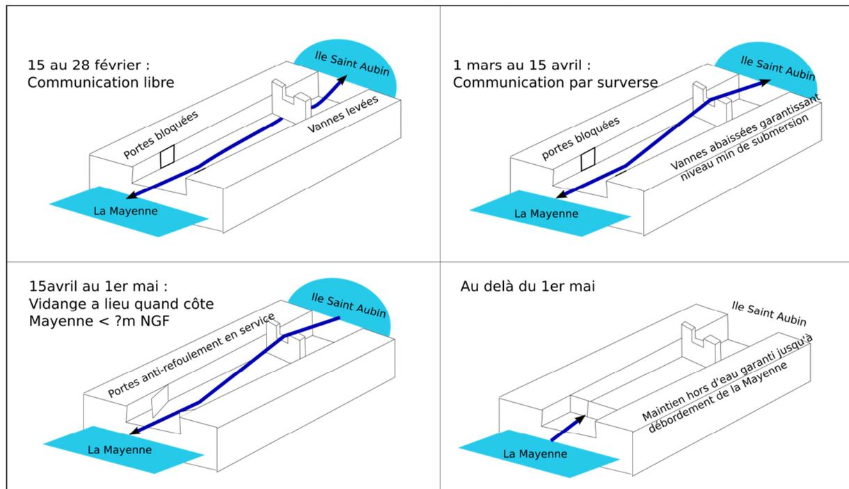
Figure 48 : principe de fonctionnement du système porte +vanne
