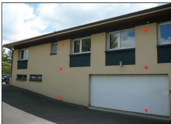
Figure 3 : Exemple de positionnement de cibles en photogrammétrie.
