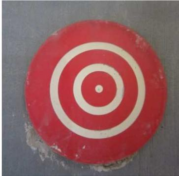
Illustration 15: Cible du réseau tachéomètre
