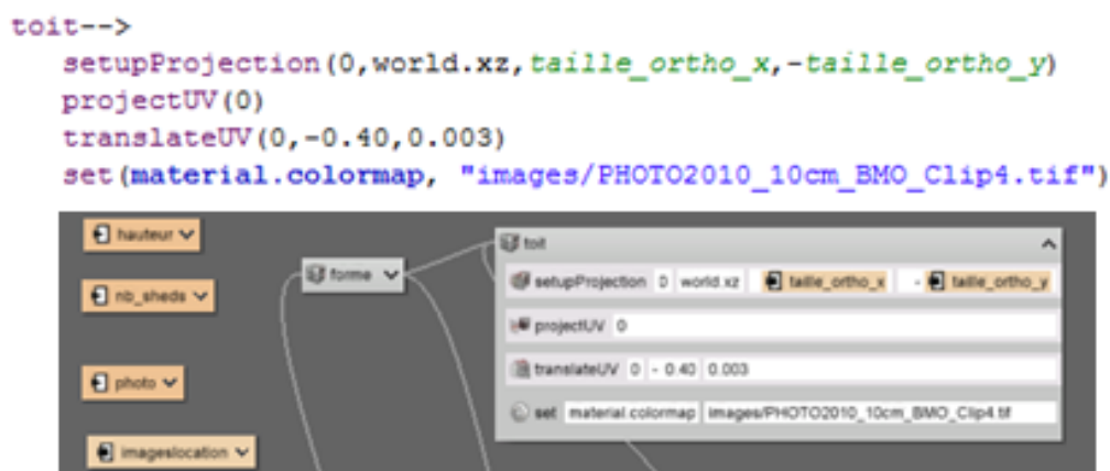
Illustration 6 : En haut une règle procédurale sous forme de code, en bas une règle procédurale sous forme de modèle de création visuel
