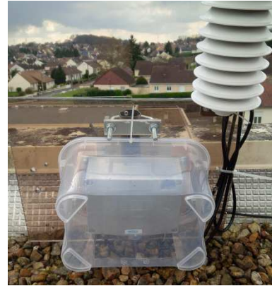
Figure 23 : Installation de la station de campagne YVRE sur le toit du collège Pasteur à Yvré l'Évêque. A gauche : antenne Ashtech CR701945 montée sur un mât haubané. A droite : station météorologique PTU300.
