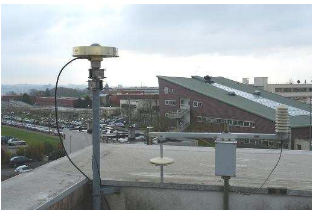
Figure 22 : Stations permanentes du RGP utilisées pour la campagne. A gauche : MAN2 et sa station météorologique (PTU200). A droite : ARNA sur la commune d'Arnage.
