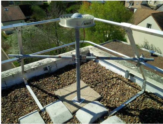
Figure 23 : Installation de la station de campagne YVRE sur le toit du collège Pasteur à Yvré l'Évêque. A gauche : antenne Ashtech CR701945 montée sur un mât haubané. A droite : station météorologique PTU300.
