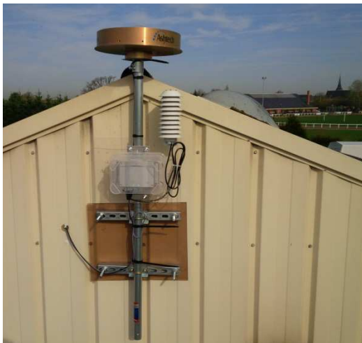
Figure 24 : Installation de la station de campagne RUAU contre le bardage d'un bâtiment municipal de la commune de Ruaudin à l'aide d'un camion nacelle. La station météorologique (PTU300) est montée sur le mât de support de l'antenne.
