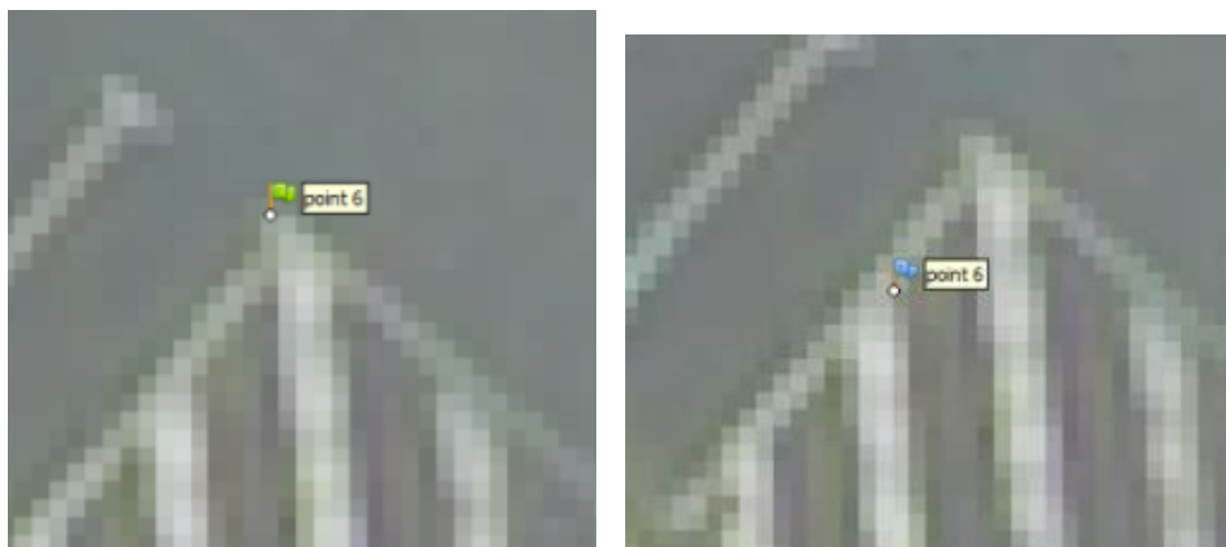
Figure 49A - marqueur bien placé (fanion vert) et marqueur généré par l'alignement des photos sur une autre photographie (fanion bleu)
