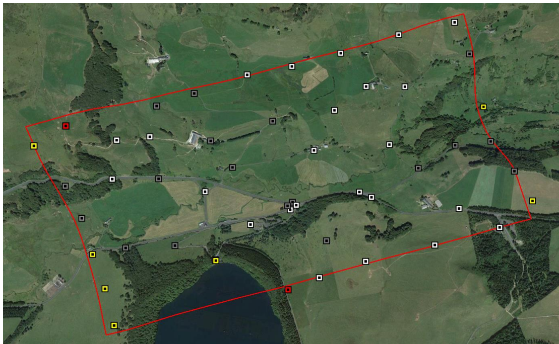
Figure 34 - Position des GCP avec le même code couleur que le Tableau 9 pour les résidus entre les points d'appui et le modèle MicMac
