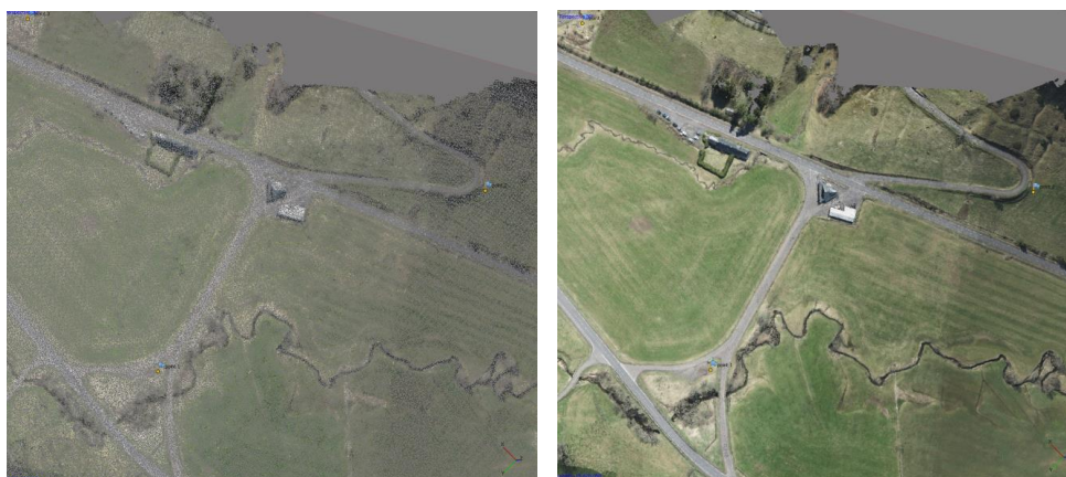
Figure 52A - Nuage dense de qualité faible (à gauche) et nuage dense de qualité haute (à droite)
