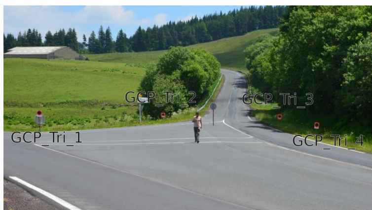
Figure 42 - Position des GCP servant au géoréférencement du nuage de point "Virage" du scanner 3D (maillage 4 de la Figure 25)
