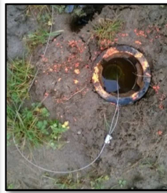
Figure 8 : Piézomètre constitué d'une bouche à clé + tube plastique + fil + sonde Diver
