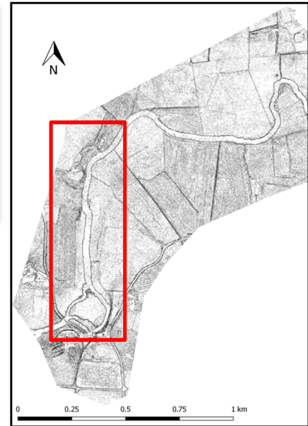
Figure 35: Points du levé Lidar au niveau du site du Moulin du Désert et alentours. En encadré rouge: emprise de la zone d'étude des stations de mesure
