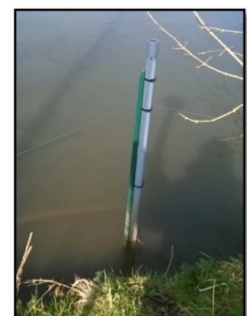
Figure 10 : Limnimètre DL3 composé d'un tube plastique + fil + sonde Diver. Site du moulin du Désert
