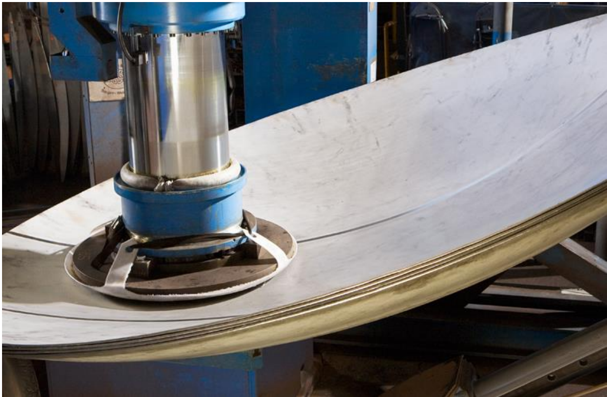
Fig.1.3 : Presse hydraulique (rotation de la plaque a déformée manuelle)
