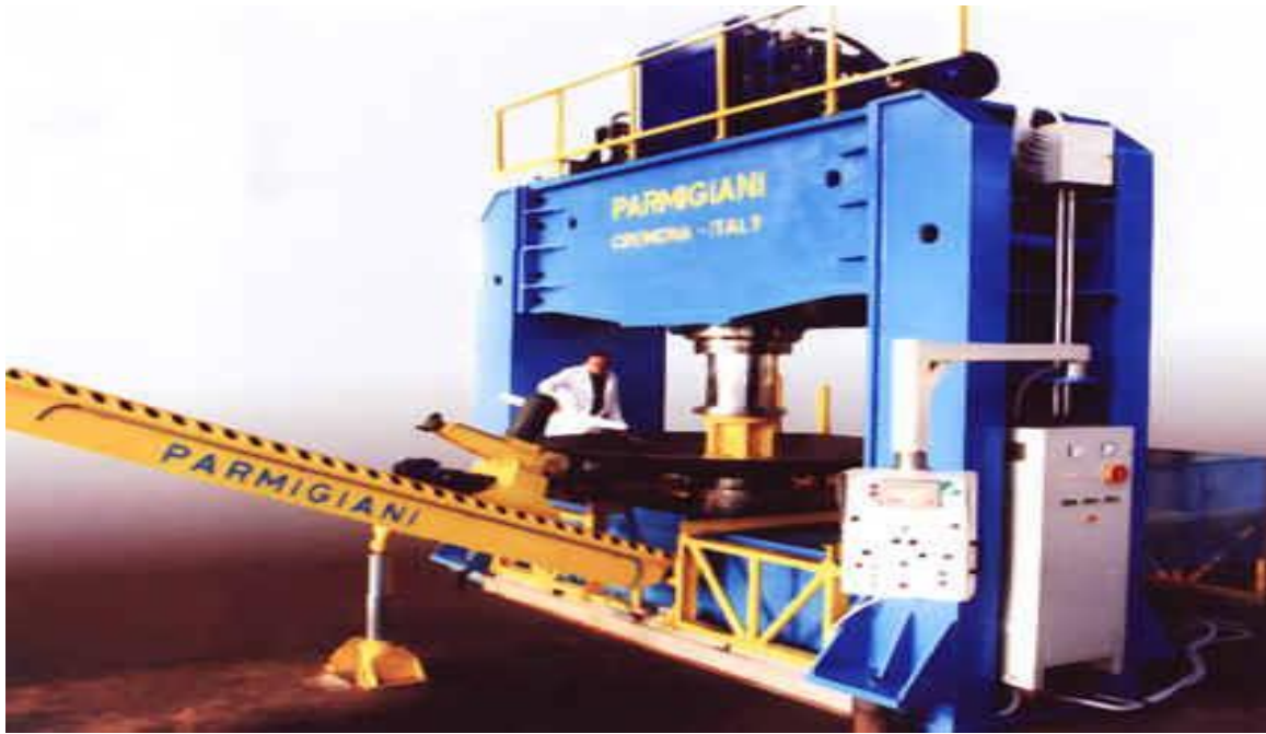
Fig.1.4 : Presse hydraulique (rotation de la plaque a déformée automatique)
