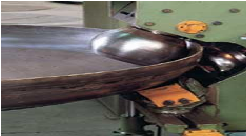
Fig.1.5 : Mécanisme de pliage en bout
