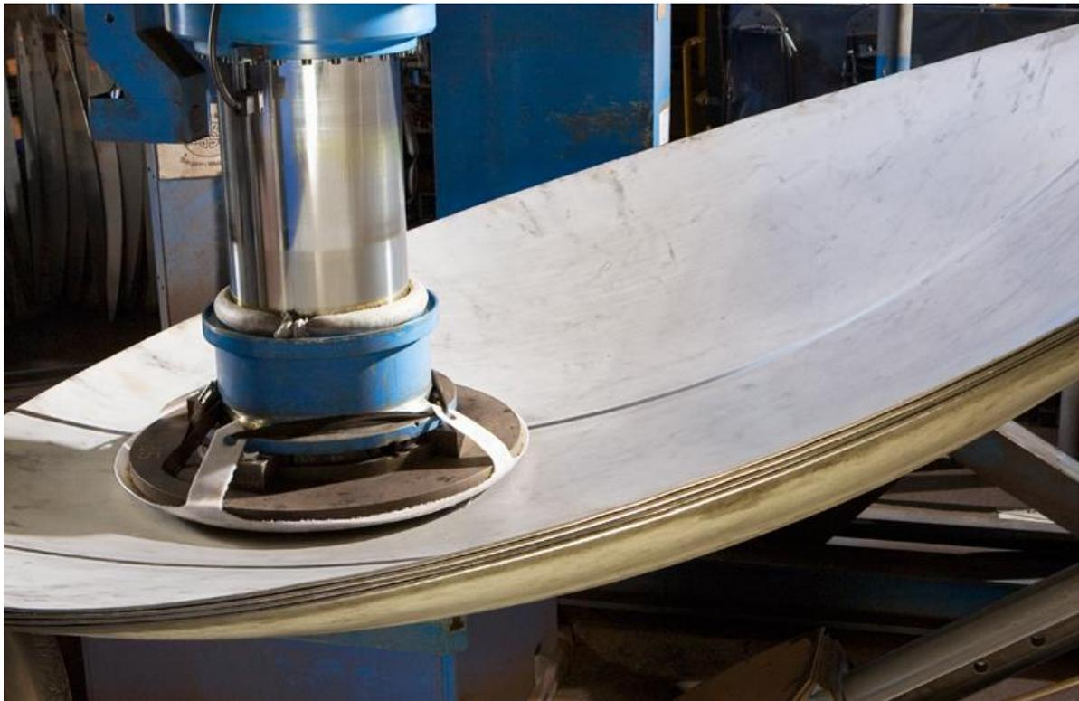
Fig.1.3 : Presse hydraulique (rotation de la plaque a déformée manuelle)
