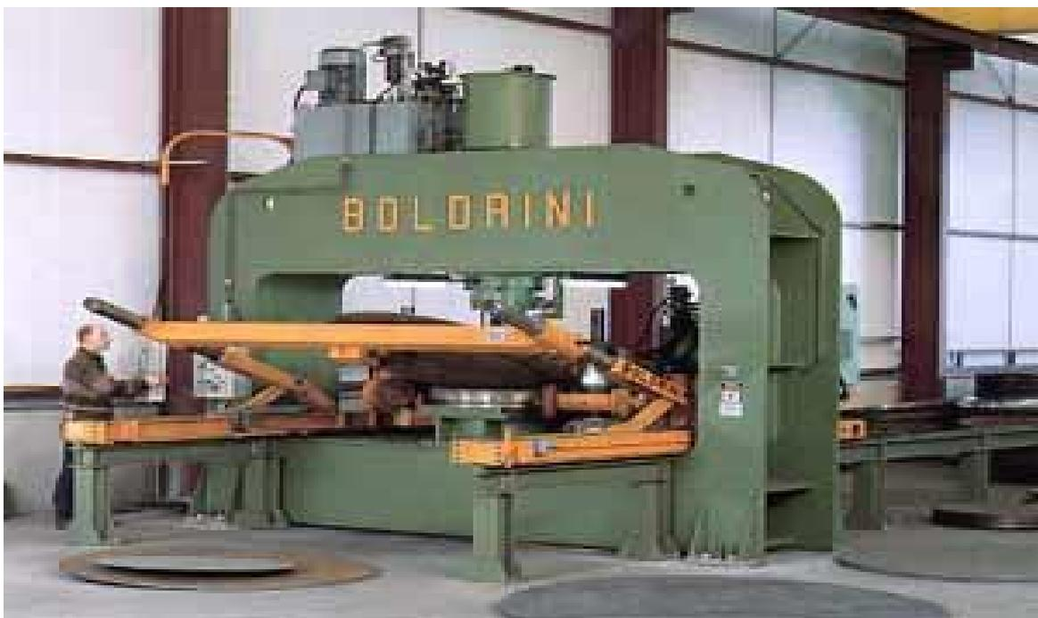
Fig.1.3 : Presse hydraulique (rotation de la plaque a déformée manuelle)
