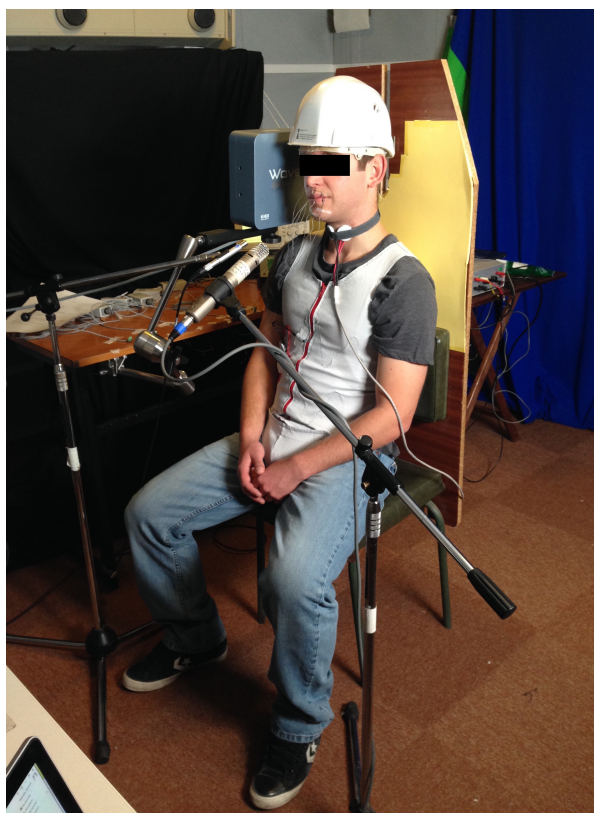
Figure 4.2.20: Positionnement du sujet à l'intérieur du champ magnétique de l'EMA
