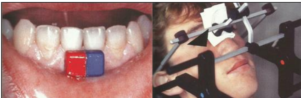
Figure 42 : Positionnement des différents éléments du Sirognathographe® (SIEMENS A.G.): à gauche émetteur magnétique, à droite support d'enregistrement magnétique [58].
