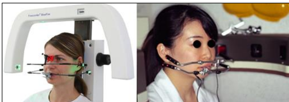
Figure 40 : Support d'enregistrement optique de la cinématique mandibulaire passif à gauche le "Freecorder®BlueFox" GmbH® et actif à droite le "TRI-MET" Tokyo-Shizaisha® [99,105].
