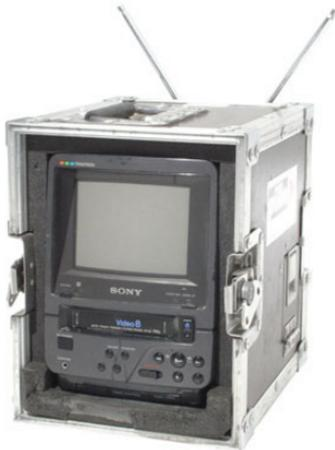
**Fig 1.19 :** Ci-contre le fameux "Combo" de Sony, sorti dans les années 80. Il s'agit en fait d'un petit téléviseur à tube cathodique couplé à un magnétoscope. Ce système permet d'enregistrer et de revoir directement les prises sur le plateau. Le terme de *Combo* est souvent utilisé pour parler de tout système permettant le monitoring et l'enregistrement/playback sur les plateaux de tournage.
