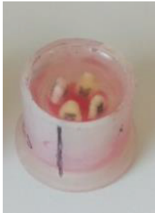
Figure 31 : Les racines sont mises en place dans le socle à l'aide de cire, puis recouvertes de résine
