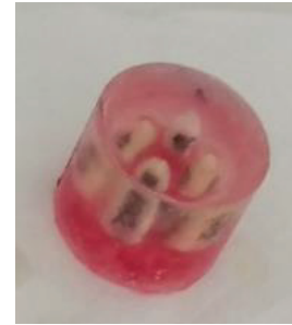
Figure 32 : Cylindre de résine après démoulage
