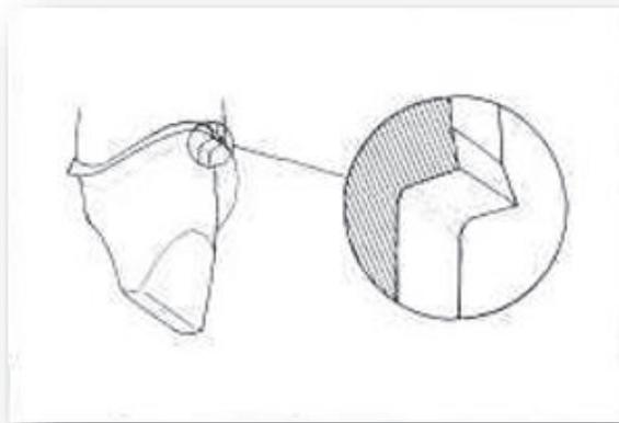
**Figure 19 : L'épaulement radial comme ligne de finition**
