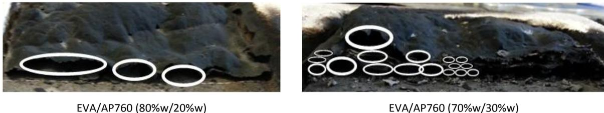
Figure 52 : Résidu observé après l'analyse obtenue au cône calorimètre des formulations EVA/AP760 chargées à 20%w et 30%w. ( $q_r=35KW/m^2$   $e=3mm$   $td=25mm$ ).
