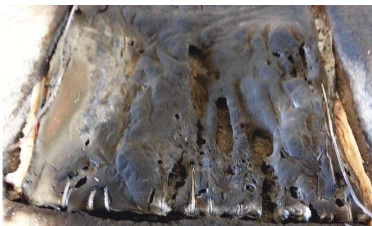
Figure 101 : Résidu observé après analyse au cône calorimètre/FTIR sans flux radiatif avec ignition forcée pour la formulation EVA/AP760 chargée à 30%w.
