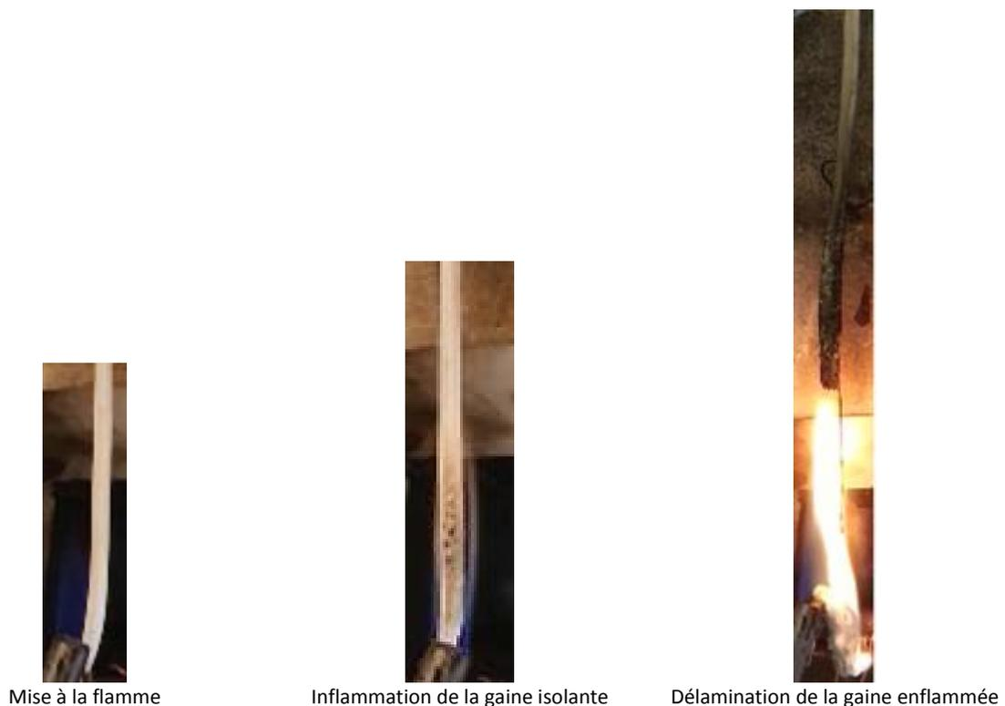
Figure 64 : Inflammation et propagation de la flamme d'un câble en EVA/AP760 chargée à 20%w en position verticale.
