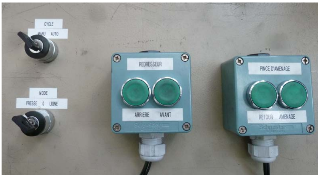
Figure 75 : commandes manuelles du redresseur et de l'amenage
