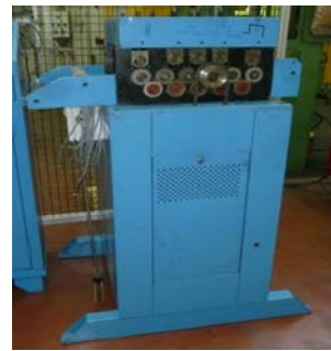
Figure 31 : tête de redresseur DIMECO 1675B
