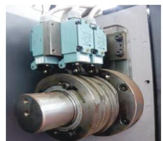
Figure 24 : capteurs de position vilebrequin sur Presse CNR4
