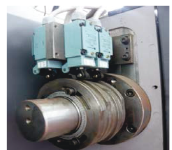
Figure 24 : capteurs de position vilebrequin sur Presse CNR4
