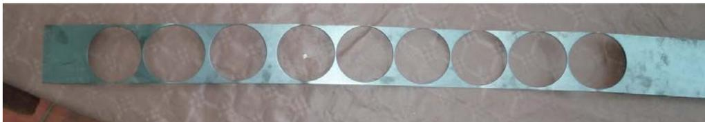
Figure 77 : Flan découpés dans une bande de tôle
