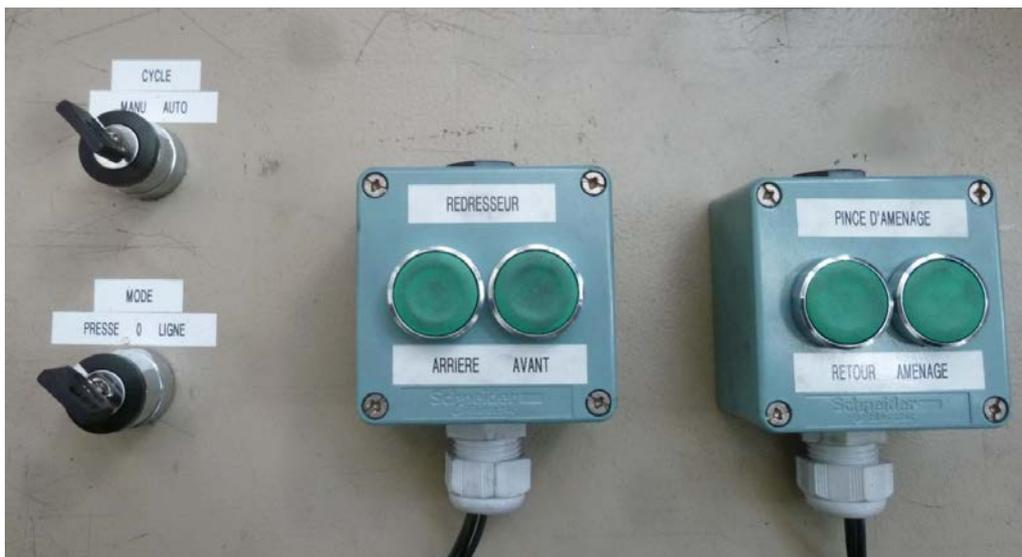
Figure 75 : commandes manuelles du redresseur et de l'amenage
