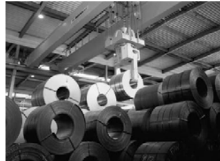
Figure 5 : Stockage de bobines (19)
