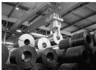
Figure 5 : Stockage de bobines (19)
