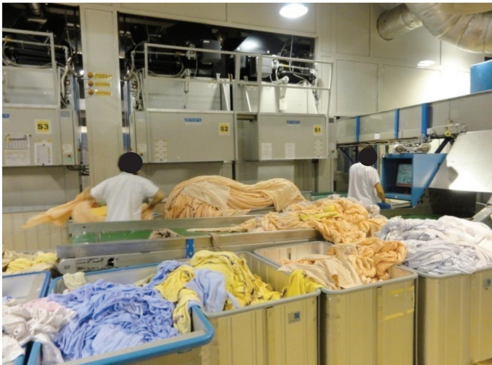
Figure 12. Tri manuel du linge propre par catégorie de linge
