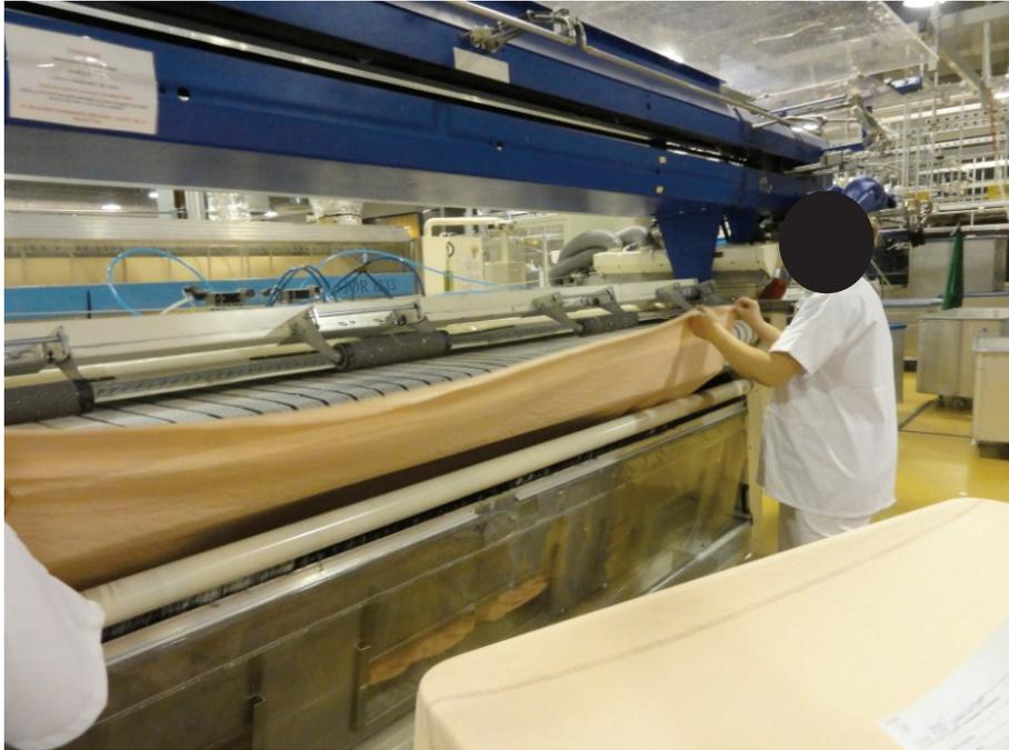
Figure 17. Chargement de l'auge de la ligne de finition.
