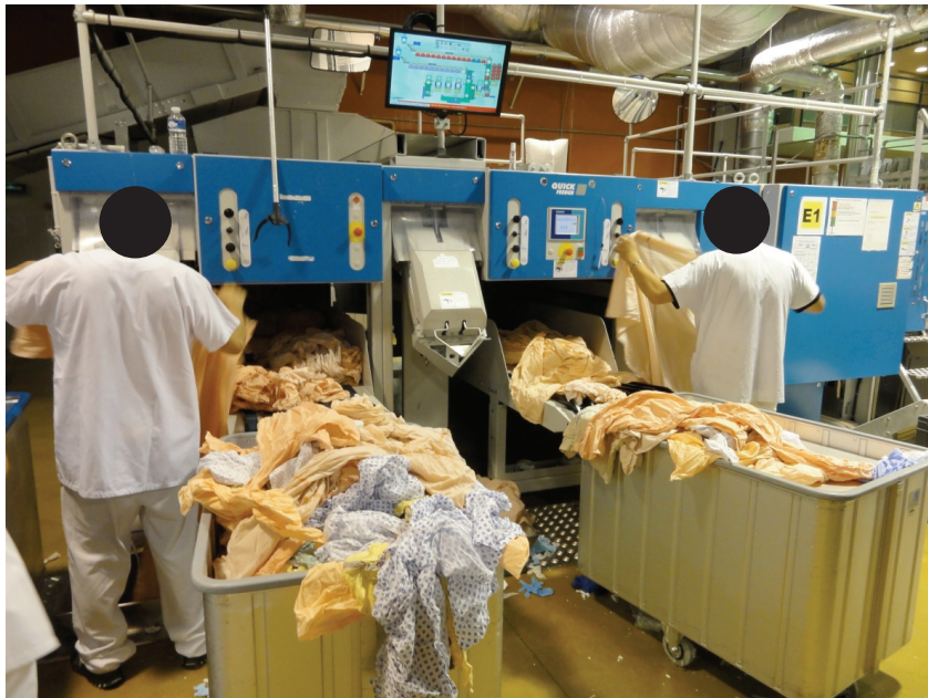
Figure 13. Engagement du drap dans la ligne de finition grand plat.
