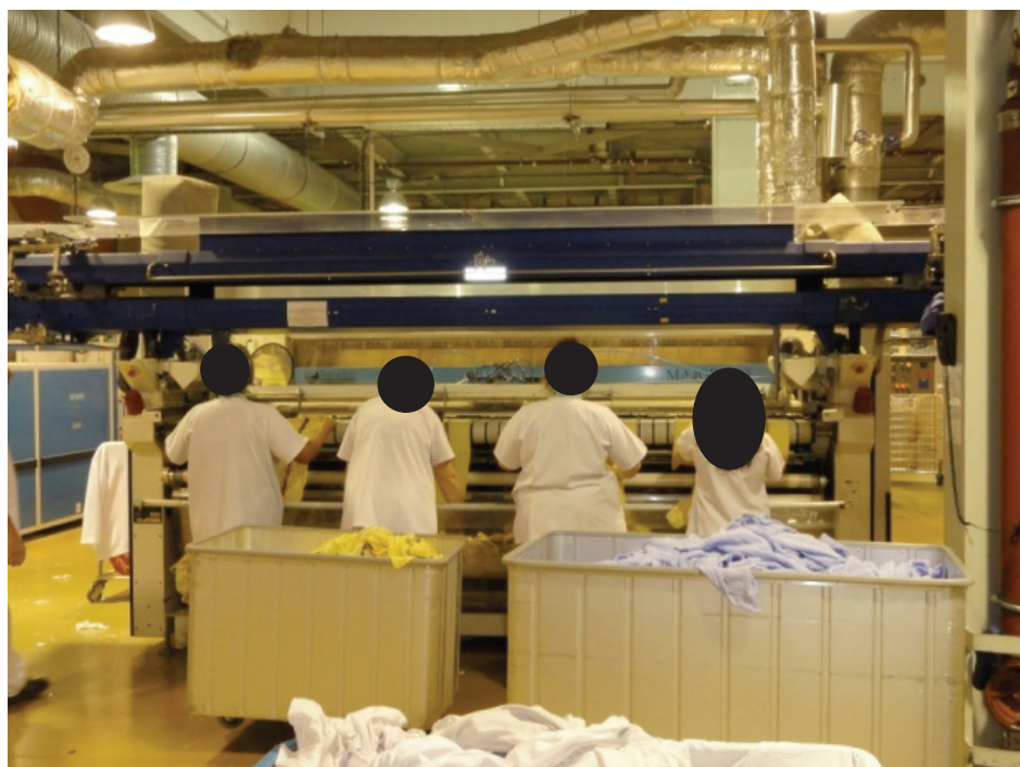
Figure 18. Engagement du petit plat sur la ligne de finition mixte.
