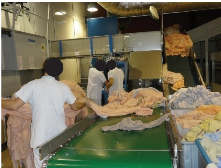
Figure 12. Tri manuel du linge propre par catégorie de linge
