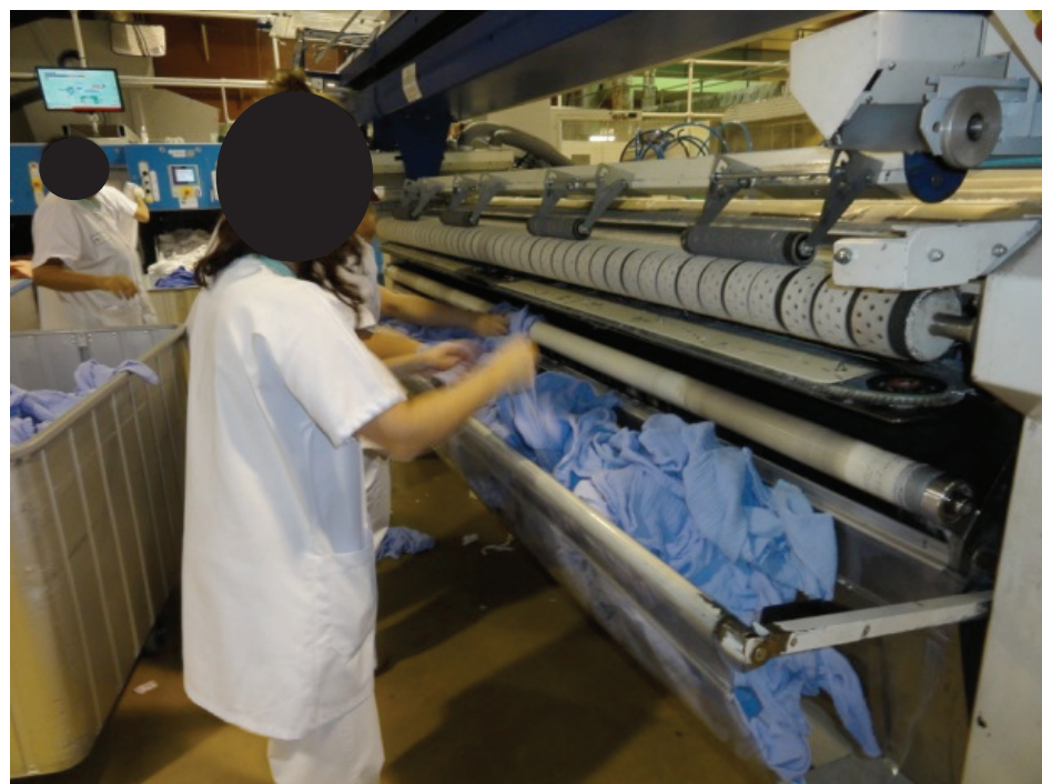
Figure 19. Engagement du petit plat sur la ligne de finition mixte.
