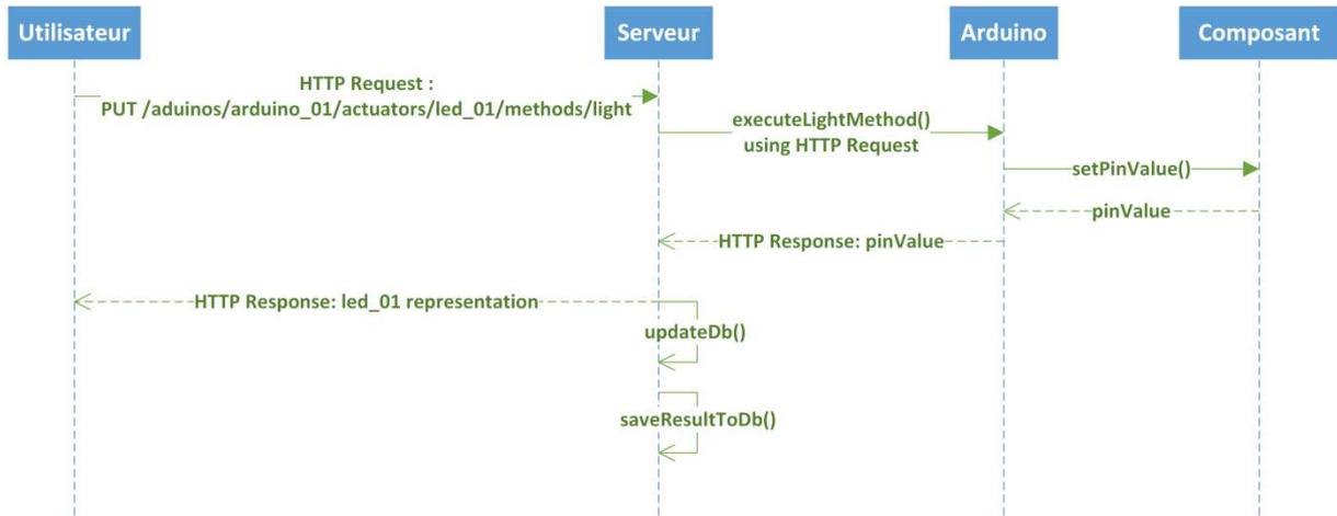
Figure 25 - Diagramme de séquence : communication unidirectionnelle
