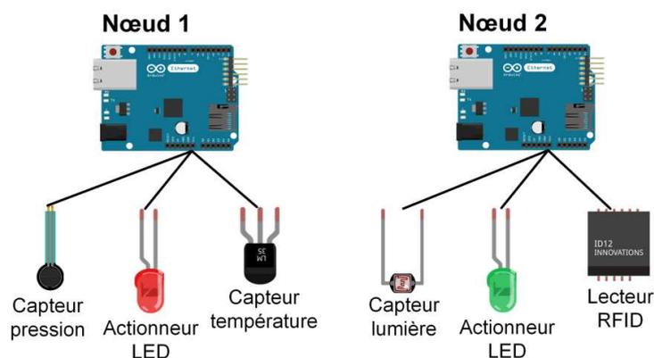
Figure 4 - Nœud de capteurs et d'actionneurs
