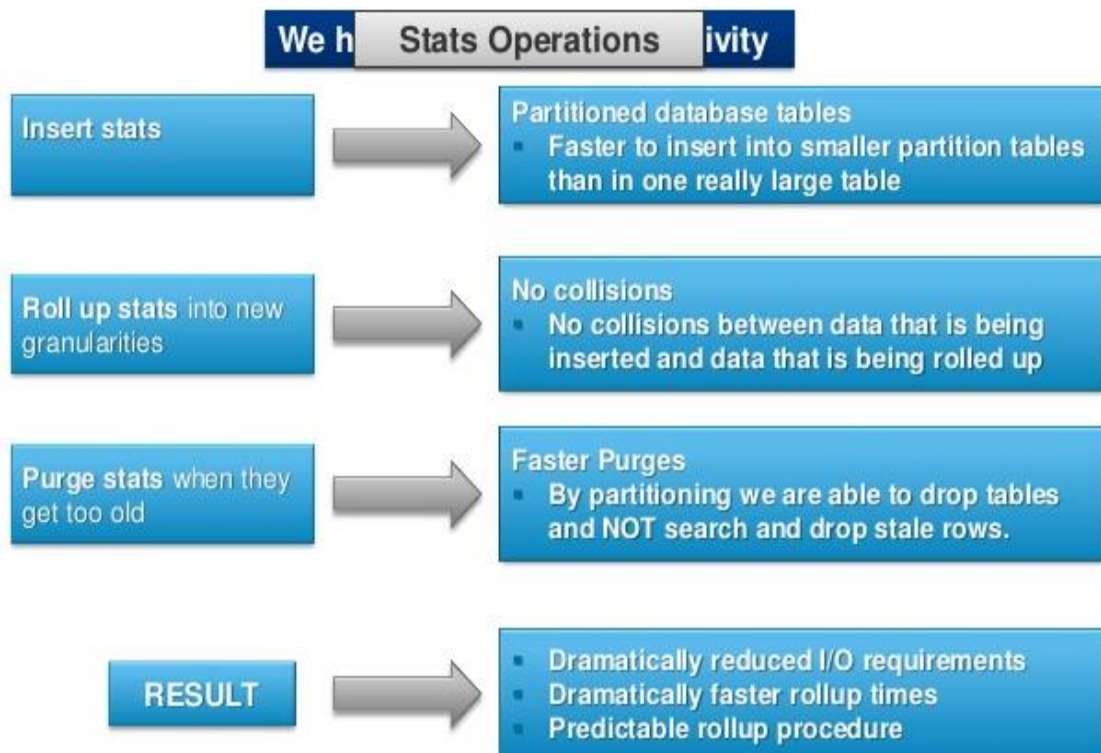
Figure 58 - Evolutions de la base de données de vCenter 5.1 par rapport à vCenter 5.0, source [22]
