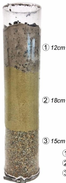
Figure 6 : Etude de la conductivité des eaux de lessivage de colonnes expérimentales en laboratoire (auteur : Quentin BRUNOT)
