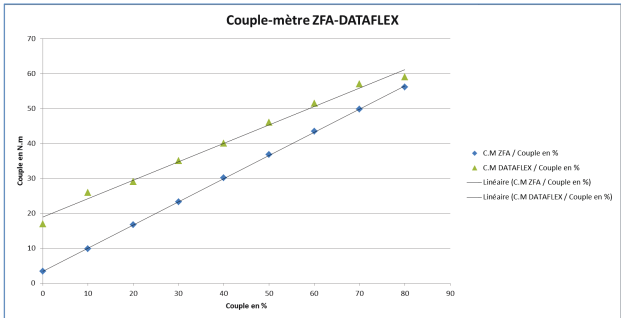
Figure 3.61 : Courbes des deux couples-mètres mode Moteur
