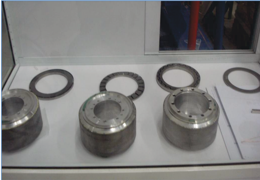
Figure 2.2. Figure présentant les différents types de rotor
