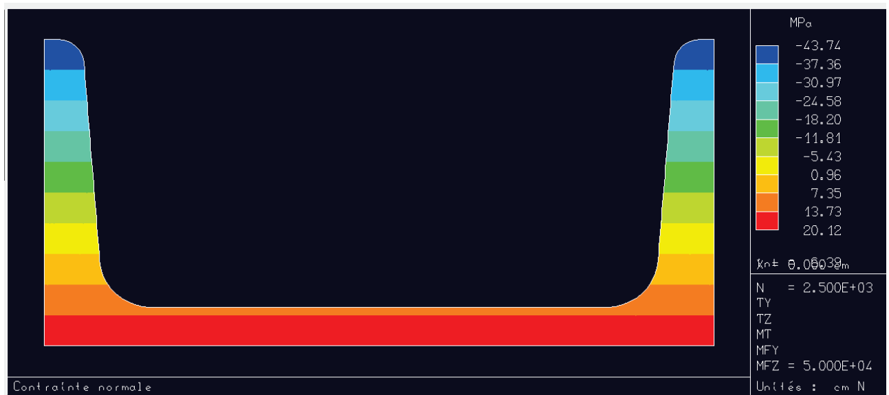
Fig.32 : Représentation des contraintes de la poutre 1.
