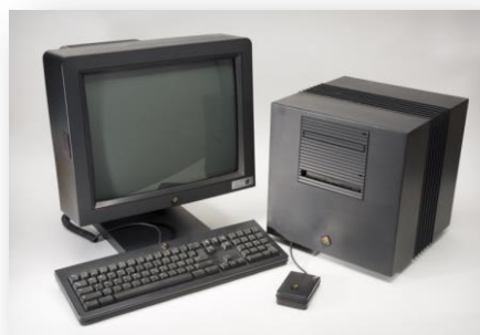
NeXT Computer : seule machine permettant d'exploiter nativement le Ariel Digital Microphone via son entrée « signal processor input »
