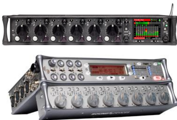
De haut en bas, Sound Devices 688 et Sound Devices 788, comportant respectivement 2 et 4 entrées compatibles AES 42.
