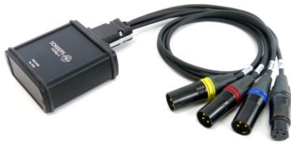
Schoeps Mini DA42. Sorties en AES 3 ou en analogique niveau ligne. Alimentation via connecteur Hirose, tension continue de 10 à 14 volts.
