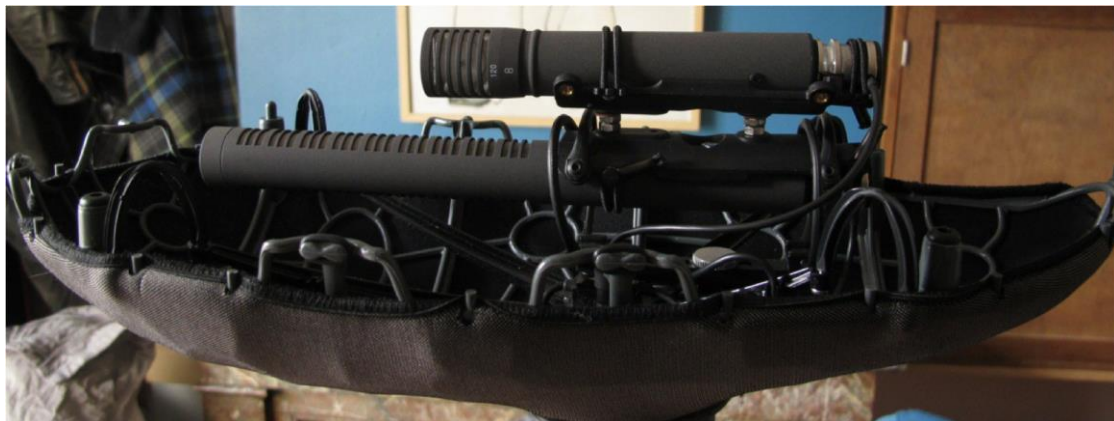
Bonnette Cinela Piano avec configuration MS numérique, utilisée par Corentin Vigot. Un KMR 81 D est associé à un KM D 120. Après décodage, l'association de ces microphones permet de créer une image stéréo.
