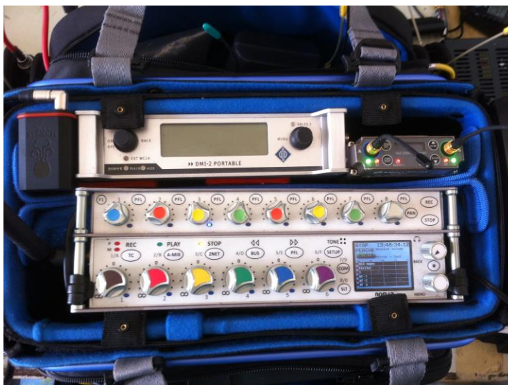
Configuration documentaire de Corentin Vigot : Neumann DMI2, enregistreur Zaxcom Nomad et système HF Wysicom.
