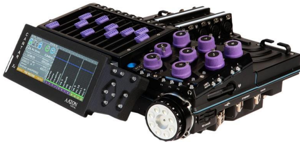
Aaton Cantar X3 : premier enregistreur portable proposant deux entrées AES 42 fonctionnant en mode 2 et permettant le dialogue avec les microphones numériques.
