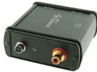
Schoeps PSD 2U. Sortie en AES 3 sur connecteur XLR 3 ou CINCH. Alimentation via connecteur Hirose, tension continue de 10 à 14 volts.
