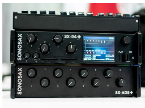
Sonosax SX R4+. Comporte jusqu'à 4 entrées AES 42.
