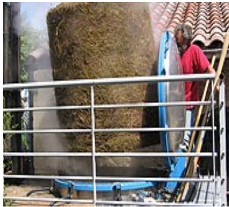
Fig. 19. Plantes aromatiques sortant de la cuve en fin de distillation
