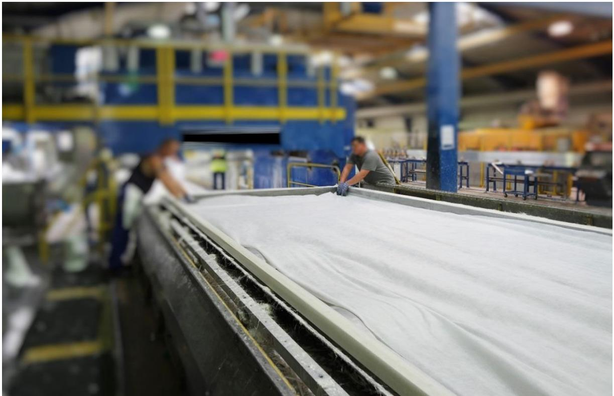
*Figure 2 : Application manuelle de nappes de tissu*
