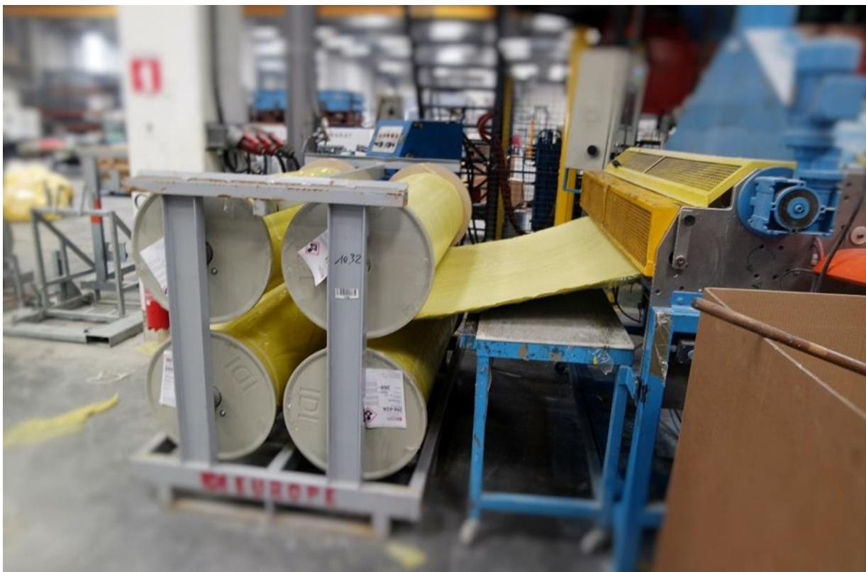
*Figure 17 : SMC - Nappes de tissu pré-imprégné*
