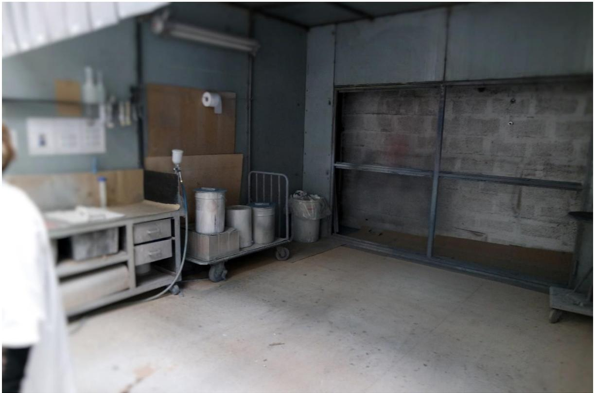
*Figure 7 : Cabine de pulvérisation manuelle de Gelcoat*
