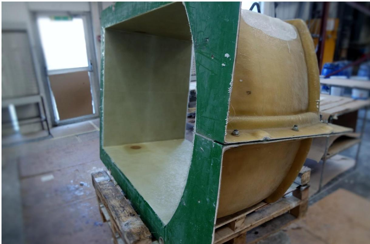
Figure 10 : Moulage contact en moule ouvert
