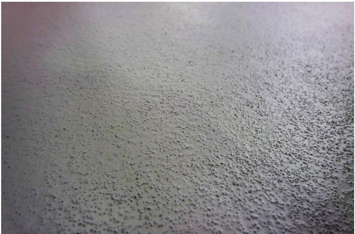
*Figure 3 : Gelcoat avec adjonction d'antidérapant*
