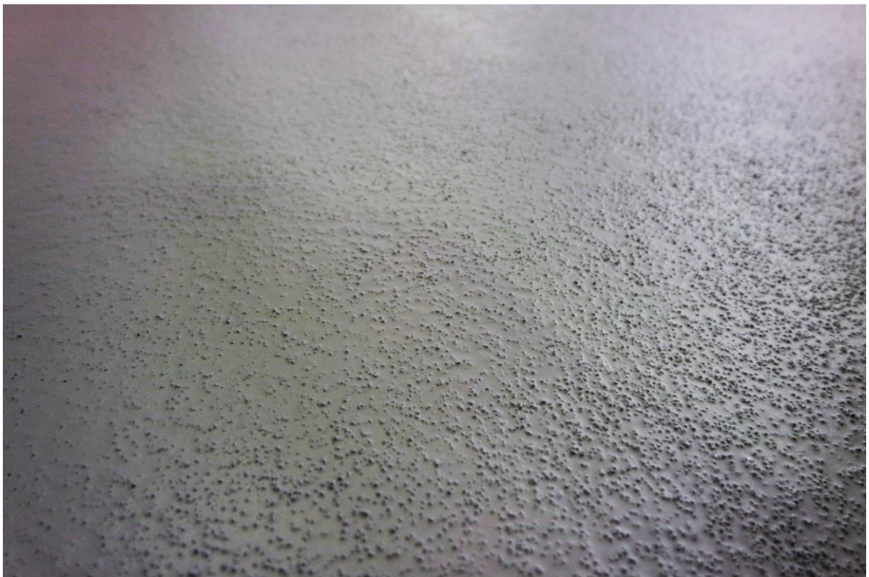
Figure 3 : Gelcoat avec adjonction d'antidérapant
