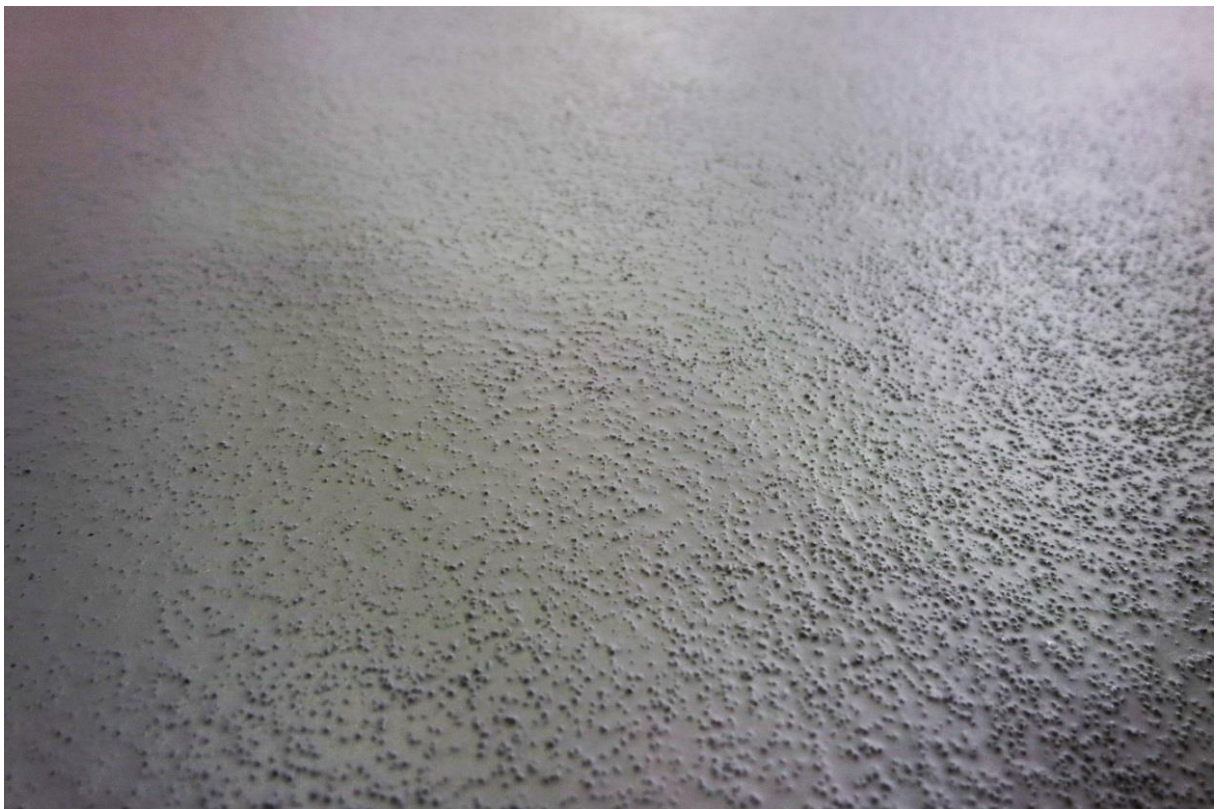
Figure 3 : Gelcoat avec adjonction d'antidérapant
