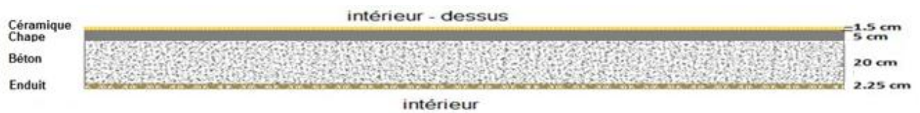
Figure 4-14 : Composition des plafonds sans isolation.
