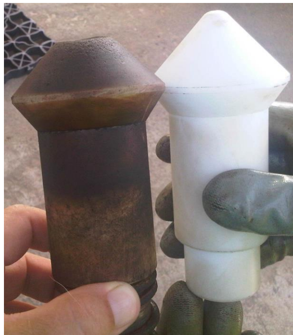
Figure 30 – Vue d'un clapet en téflon neuf et usé
