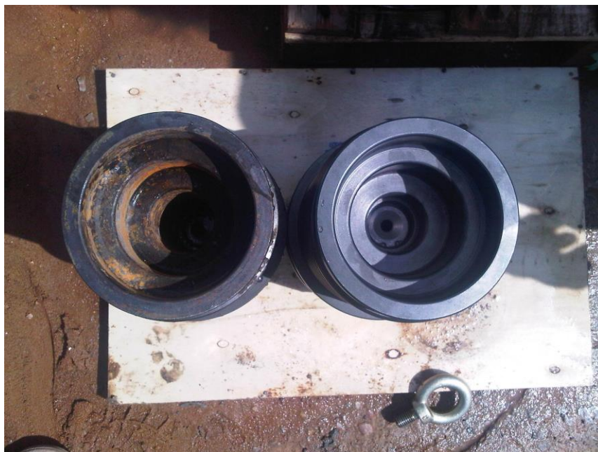
Figure 27 – Vue des anciennes têtes de marteau et des nouvelles avec trou calibré
