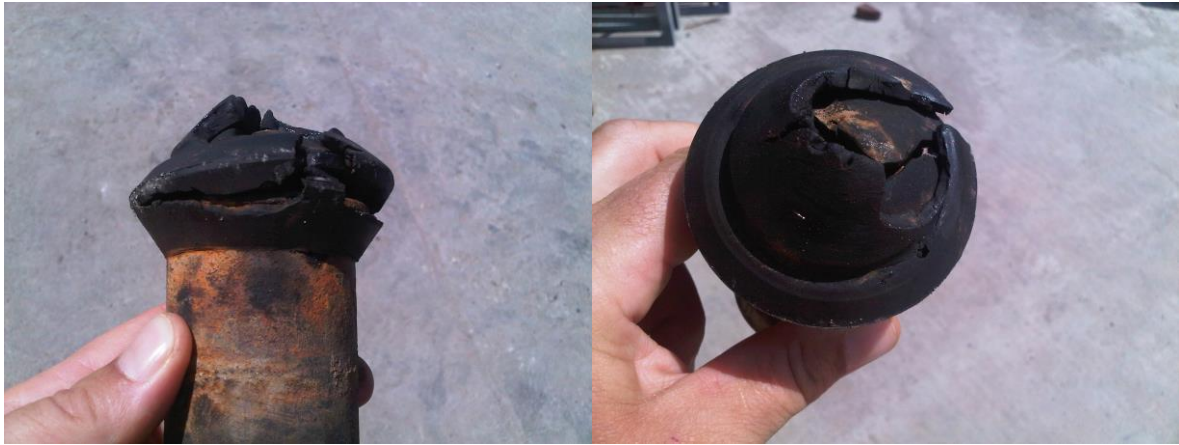
Figure 29 – Vue d'un clapet endommagé
