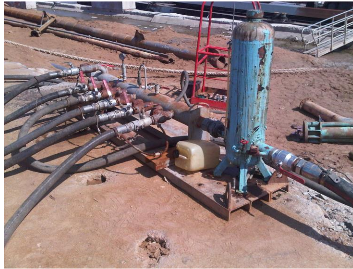
Figure 22 – Vue de la clarinette et du graisseur de ligne
