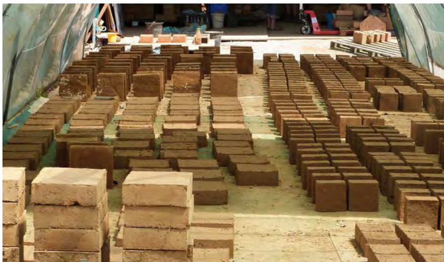
Figure 32. Ci-dessus — Briques d'adobe en cours de séchage ; Photographie de Novabuild ; 2014
