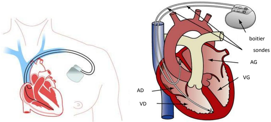
**Figure 17 :** Positionnement du boîtier et des sondes
