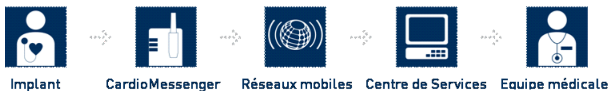
Figure 23 : Communication des données de la prothèse
