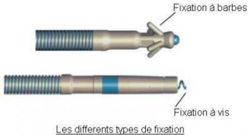
Figure 16 : Les différentes extrémités des sondes
