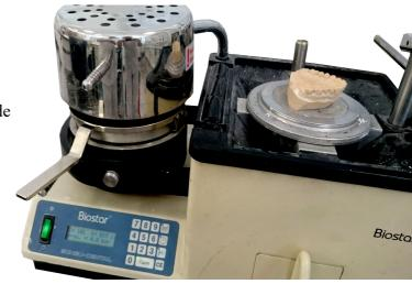
On retire ensuite la résistance et on bascule rapidement la cuve de pression sur le moulage en plâtre.
