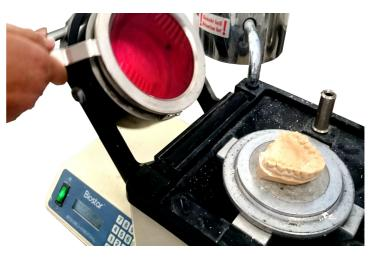
On verrouille le système et on attend environ 20 secondes pour pressuriser la cuve. La feuille plastique ramollie est estampée sur le moulage par aspiration
