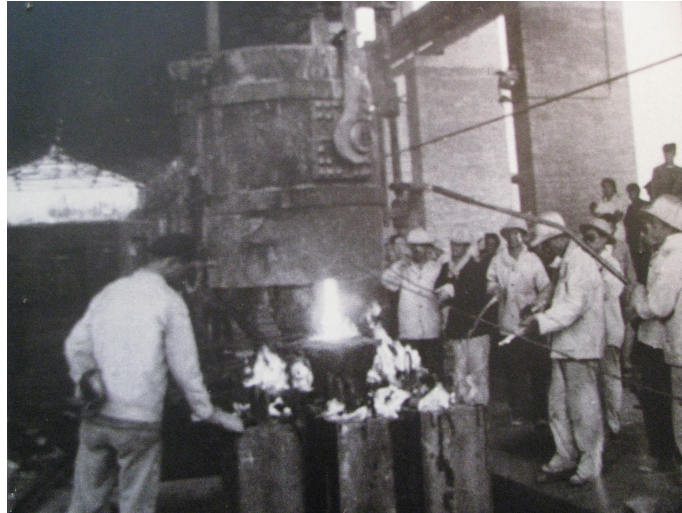
Image 3 : le premier convertisseur à soufflage latéral de Shougang en 1958 Photographie issue de l'Entreprise du développement culturel de Shougang
