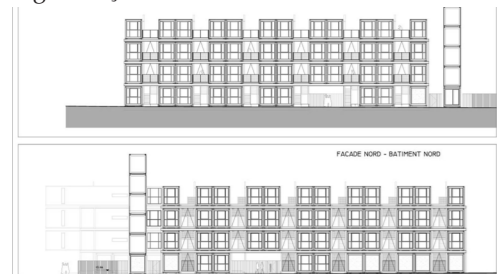
Fig.95: façades Sud et Nord, Bâtiment Nord.
