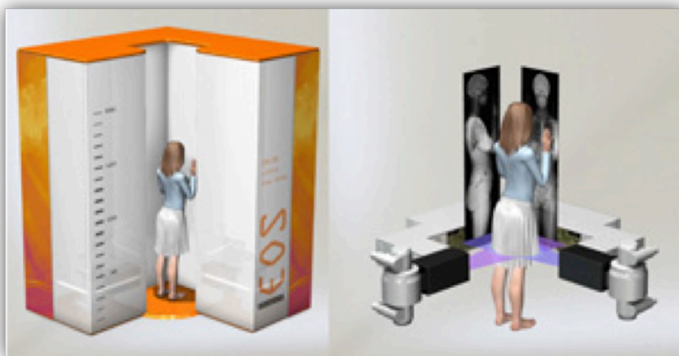
Figure 1 : Principe du fonctionnement EOS® 2D/3D par double balayage vertical de rayons X. (Illustrations EOS®)
