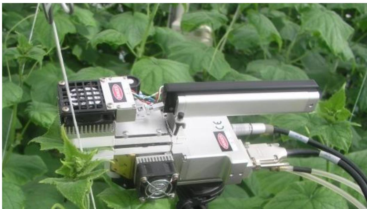
Figure 12 Visualisation de la chambre de mesure de l'appareil Li6400 XT en situation de mesure. La pince permet de fixer la chambre de mesure de manière hermétique sur la feuille à mesurer (source personnelle)
