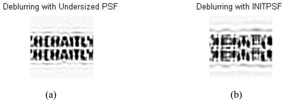
Figure V.54. (a).Première étape: restauration avec minimisation de la taille de PSF ou (with Undersized PSF). (b).Deuxième étape: restauration avec la même taille initiale (with true PSF)
