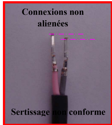
Figure 25 : Connexions non alignées
