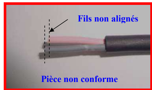
Figure 16 : Pièce non conforme
