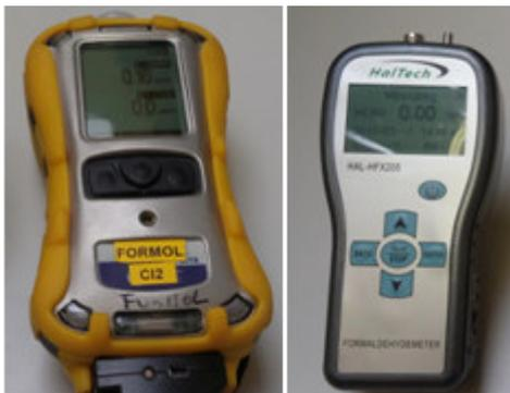
Photographies des détecteurs électrochimiques de formaldéhyde (utilisés dans le cas concret n° 1)
