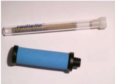
Photographie d'une cartouche et du corps diffusif dans lequel elle doit être introduite pour le prélèvement
