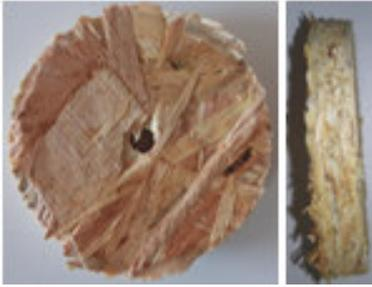
Photographies de chutes de bois (OSB) issues d'une construction de maison en ossature bois
