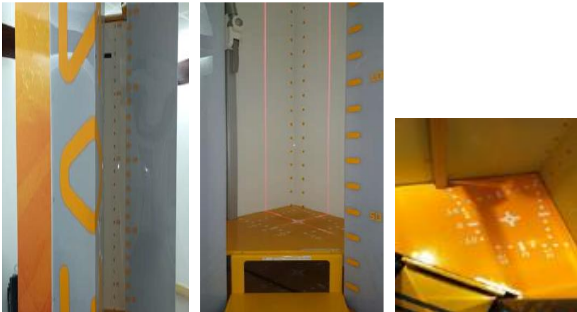
Figure 18: Cabine EOS à l'hôpital Cochin. A noter les faisceaux lasers pour définir les limites de l'acquisition et les marquages au sol pour aider au positionnement du patient dans la cabine.
