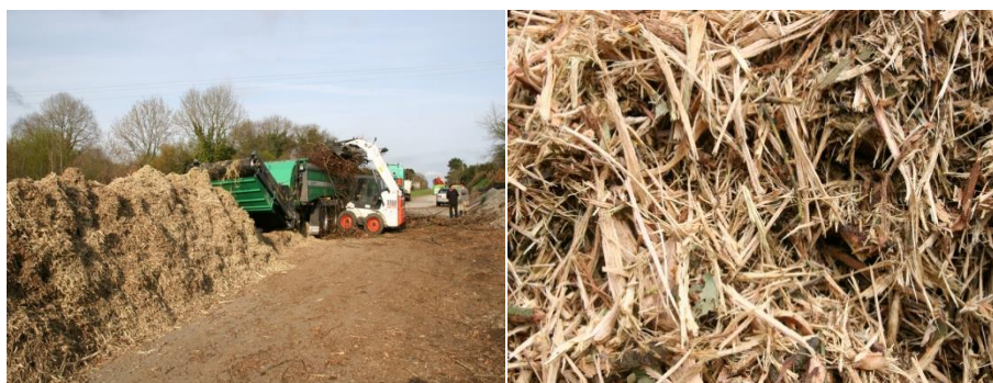
Figure 3 : Broyage des branchages à l'aide d'une déchiqueteuse à marteaux et résultat du broyage (source : PNRGM)
