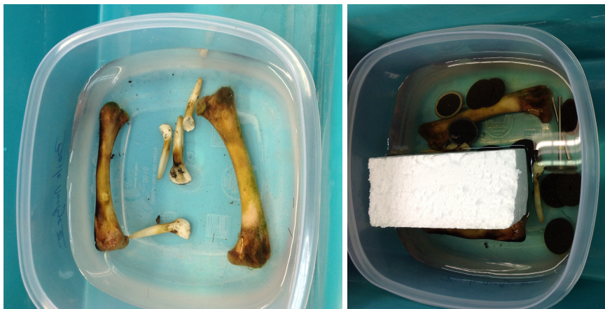
Figure 8: Os de poulet et dents de veau immergés dans la solution à 2M/L de NaOH (photo : Jane Gourgues)
