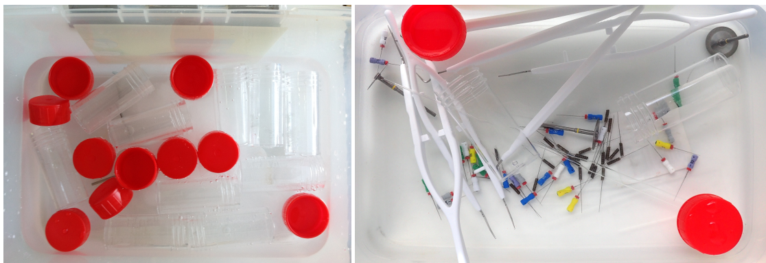
Figure 4: Instrumentation dans la solution à 2M/L de NaOH (photo : Jane Gourgues)
